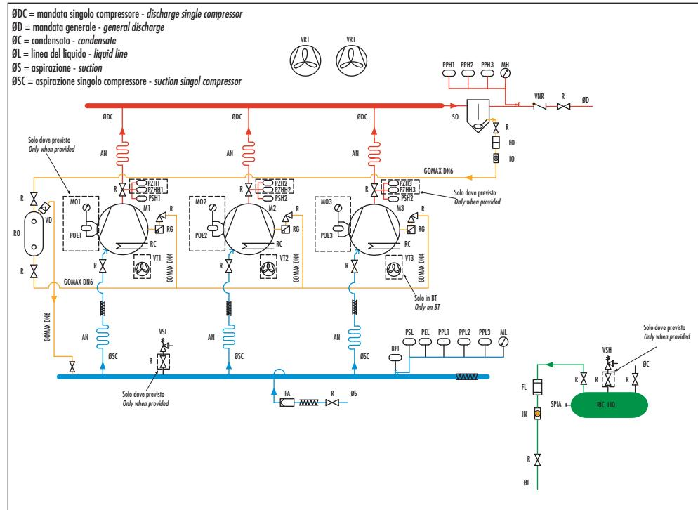
Circuito frigorifero standard per compressori Scroll con iniezione del liquido
